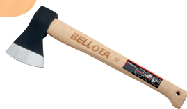
HACHA VIZCAINA BELLOTA Mango madera. Cabeza forjada en una sola pieza. Tratamiento diferenciado entre ojo y filo para evitar roturas.
