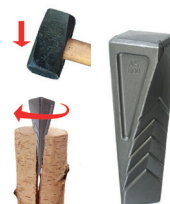
CUÑA HELICOIDAL 9684280 Peso: 800 grs.. Su forma helicoidal facilita el rajado del tronco a cada golpe, rompe por rotación. Con doble ranura y ranuras antirretorno. 24 95
