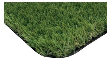
Compuesto por filamentos en forma de "C", de 30 mm de altura. Con 15.750 puntadas por m<sup>2</sup> y densidad: 7.000 Dtex. Efecto memoria.
