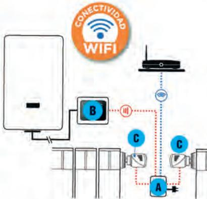
**Configuración** de un dispositivo para el control de los radiadores de calefacción central.
